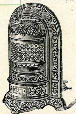
"Le Bijou". CALORIFÈRE à gaz absolument sans odeur, consommant environ 300 litres de gaz à l'heure, capacité de chauffage 50 mètres cubes. Fonte fine Email noir Email céramique 26 fr. 30 fr. 32 fr.
